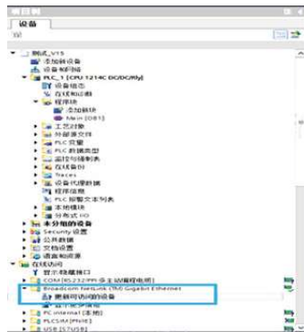
图6 在线分配设备IP地址和设备名称
